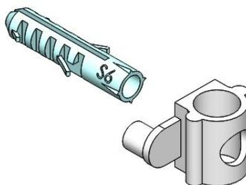
1.3. Coloque a bucha na parede, ajuste-a. Em seguida, promova a fixação total da peça;
