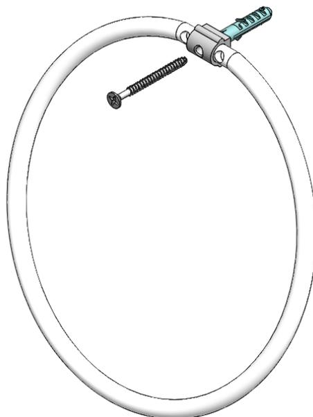
1.4. Terminada a fixação, recoloque a tampa frontal.
