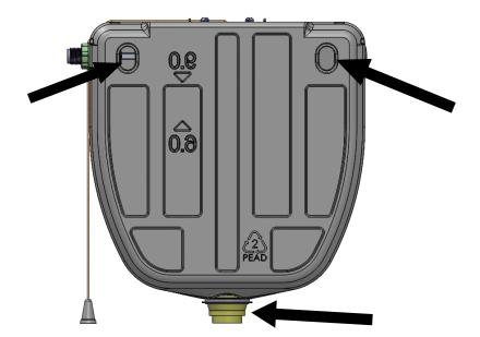
4.4. A entrada d'água vem instalada do lado esquerdo da caixa. Caso haja necessidade de instalação do lado direito, inverta os componentes para o outro lado. Recomenda-se que a ligação de água seja feita com engate flexível. Importante após a instalação do engate, confirmar se a boia não está "presa" no tubo extravasor (pistão).
