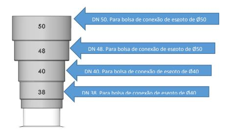
Para instalar o sifão em lavatórios ou tanques, utilize a bucha de redução respectiva a louça utilizada rosqueando-a na válvula de 7/8" ou 1 %";
